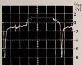
Bild 5. Basis-Emitter-Spannung U_{BE} von T1 bei einem Strahlstrom I_{SV} von 0,1 mA (Horizontalablenkung 10 µs/Rastertlg.)
